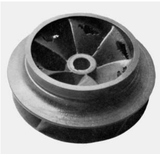
Roue de pompe radiale détruite par cavitation
